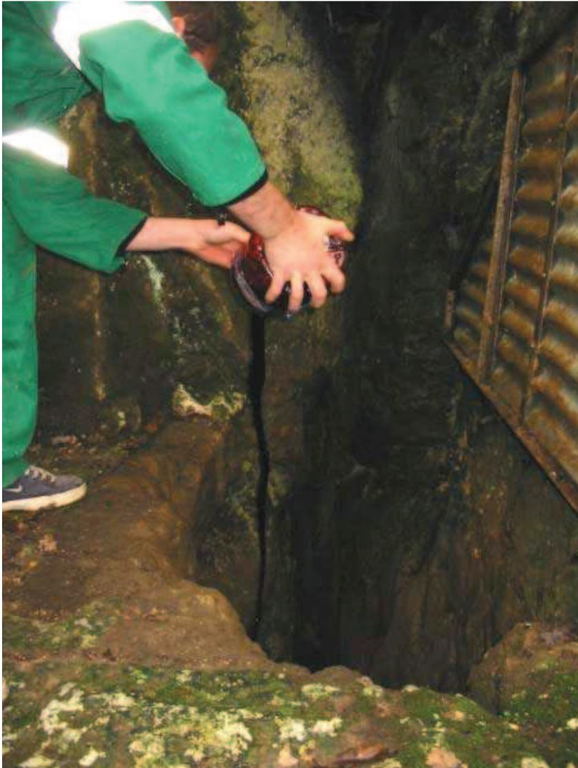
*Figure n°2. Injection du traceur sur le site de la perte de la Poirelle*
