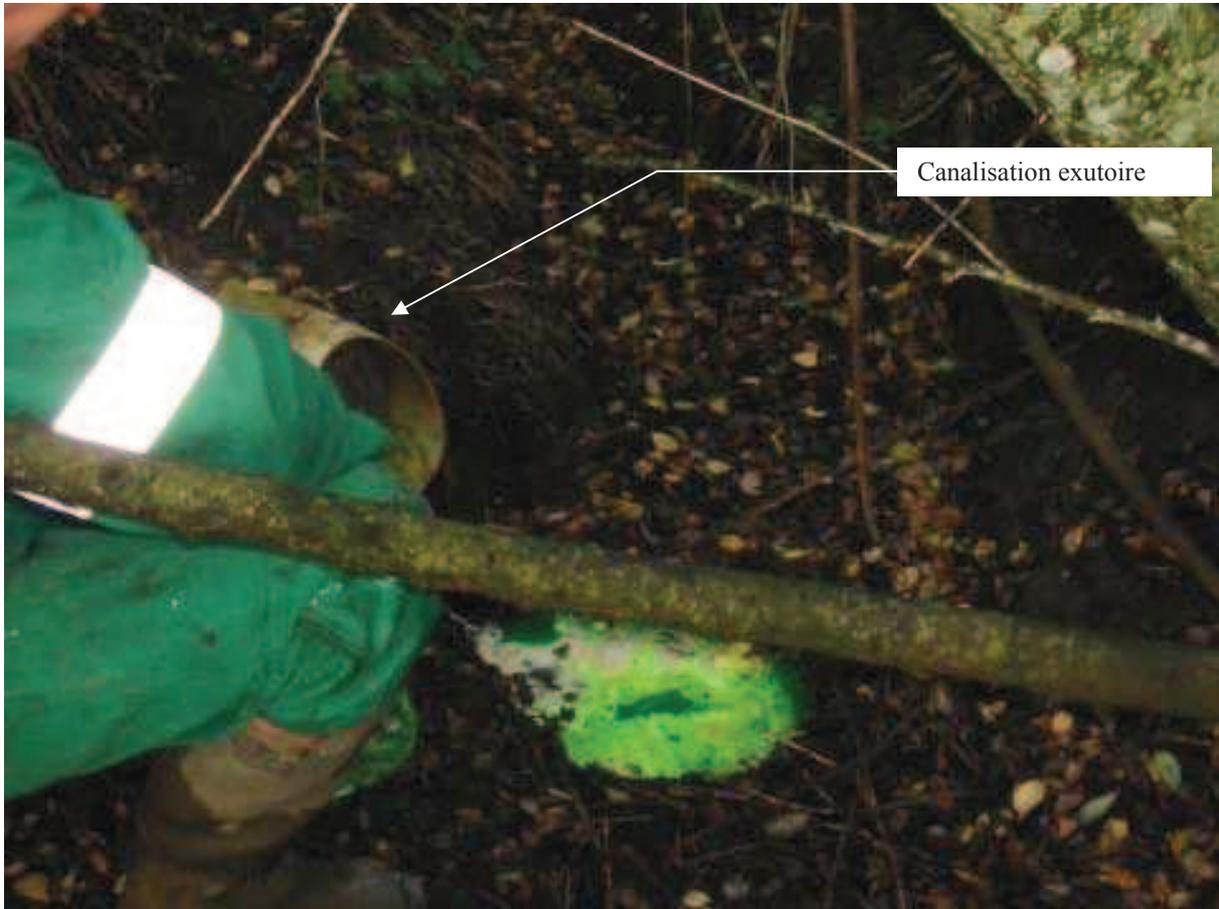
*Figure n°3. Injection du traceur sur le site de la perte de l'étang Gousseau*
